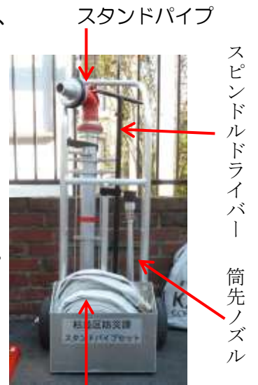
スタンドパイプ スピンドルドライバー 筒先ノズル ホース 水栓キー
